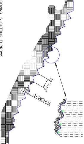
GROOVING IS CUTTING FURROWS ALONG THE CONTOUR OF A SLOPE. IRREGULARITIES IN THE SOIL SURFACE CATCH RAINWATER AND PROVIDE SOME COVERAGE OF LIME, FERTILIZER AND SEED.
